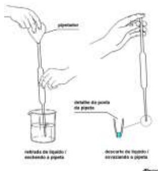
Figura 2. Utilização de pipeta volumétrica. O volume restante na ponta da pipeta não deve ser retirado - o volume correto já leva em conta este resíduo
